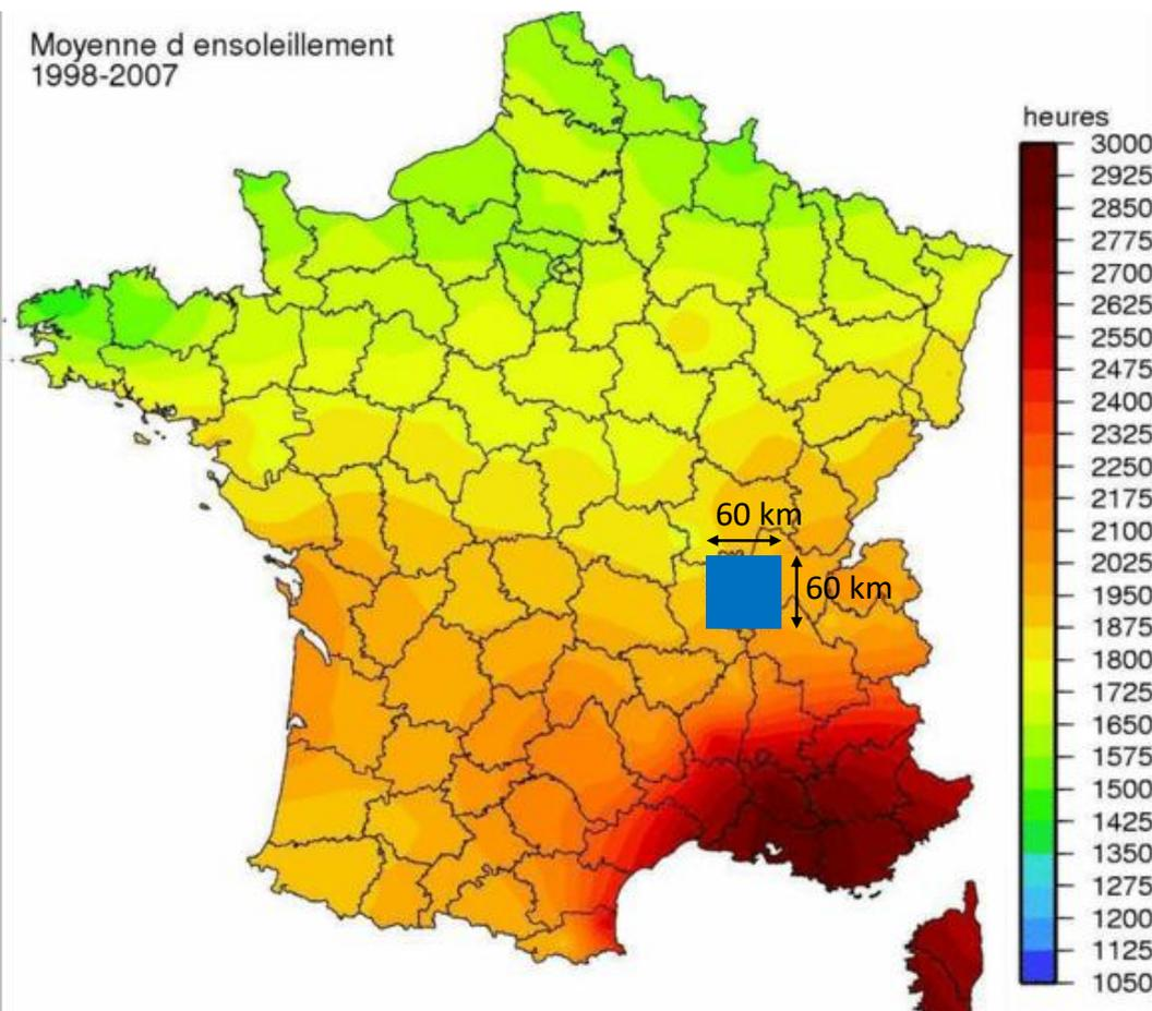
**3600 km<sup>2</sup> de cellules solaires photovoltaïques au silicium (légèrement supérieure à la surface du département du Rhône) permettrait de fournir la totalité de la consommation annuelle 2015 d'électricité de la France.**
